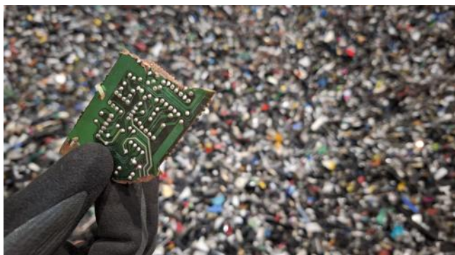
Une fois l'appareil dépollué, il est fragmenté pour séparer les matières. Photo Serge Spadillero
